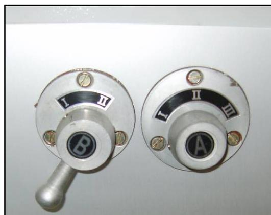
Figura 15 – Manopole di regolazione della velocità del mandrino.
