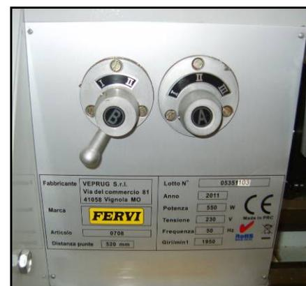
Figura 4 – Quadro regolazione velocità.
