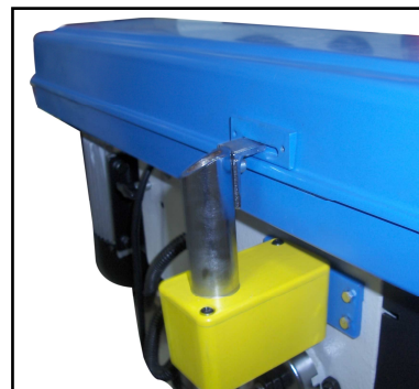
Figura 17 – Blocco del vano pulegge.
