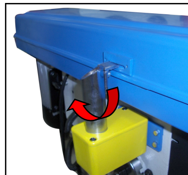
Figura 13 – Blocco vano pulegge.
