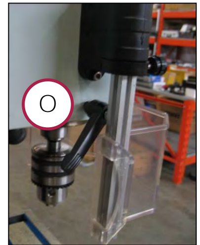
Figura 11 - Leva di blocco del mandrino.
