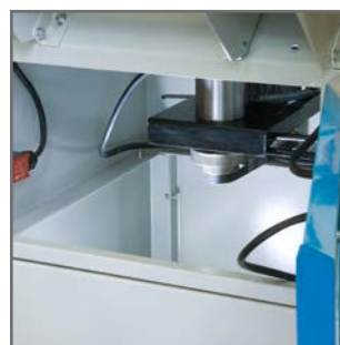
La caja cambio velocidad con microinterruptor
