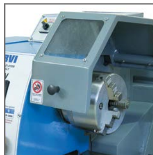
Proteccion para plato
