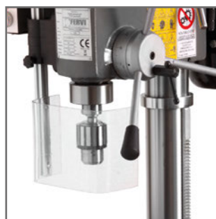
Protección de seguridad para portabrocaW
