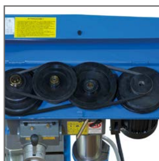
Carter trasmissione con micro interruttore
