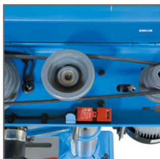
Carter trasmissione con micro interruttore
