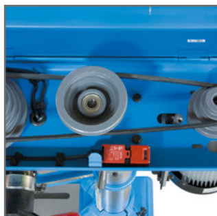
Carter trasmissione con micro interruttore
