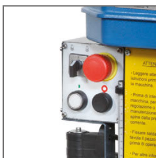
Pannello di controllo
