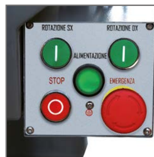
Pannello controllo fresa orizzontale
