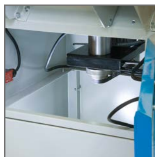
Vano cambio velocità con micro interruttore
