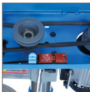
Carter trasmissione con micro interruttore
