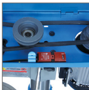
Carter trasmissione con micro interruttore
