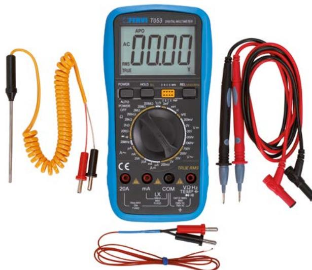
CON SONDA PER MISURAZIONE TEMPERATURA, CONTINUITÀ SONORA E CONTROLLO DIODI
