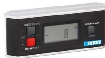
FUNZIONI: 0 ÷ 90° IN TUTTE LE 4 DIREZIONI, INCLINAZIONE mm/m, INCLINAZIONE in/ft, PERCENTUALE D'INCLINAZIONE %, RETROILLUMINAZIONE, AUTOSPEGNIMENTO, MISURAZIONE ASSOLUTA (ABS) E RELATIVA, INVERSIONE AUTOMATICA DEI NUMERI PER LETTURE SOTTOSOPRA, CON SEGNALE ACUSTICO
