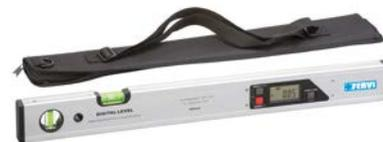
MAGNETICA CON CORPO IN ALLUMINIO E BASE FRESATA, AUTOSPEGNIMENTO, SCHERMO RETROILLUMINATO, 2 FIALE, FUNZIONE "HOLD", RICERCA DEL 0° E 90° SONORO, LETTURA: ASSOLUTA E RELATIVA, GRADI, PERCENTUALE, mm/m E in/ft, BORSA PER IL TRASPORTO
