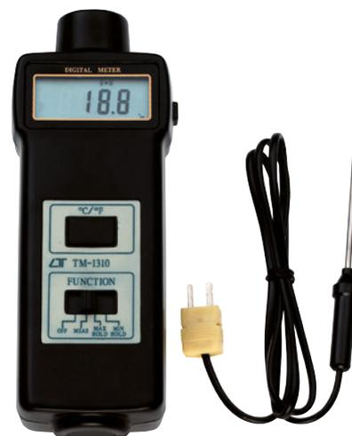
SONDE TIPO "K" PER AMBIENTE E PER IMMERSIONE CON CUSTODIA IN PLASTICA
