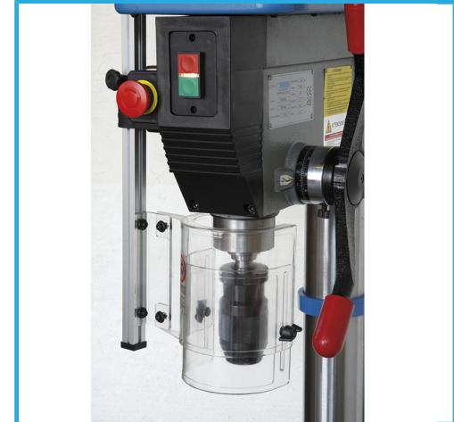
**Capacidad de perforado en fundición con agujero previo** Ø 32 mm
