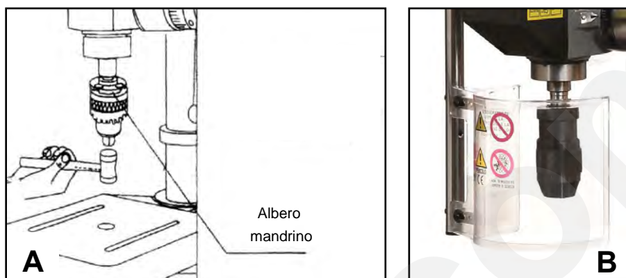
Figura 7 - mandrino (A: battere col martello - B: vista d'insieme).
