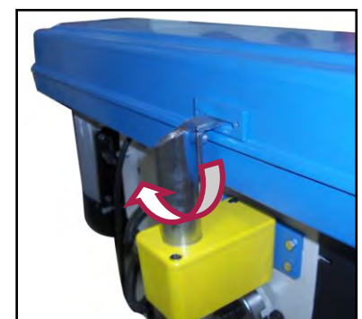
Figura 22 – Blocco vano pulegge.
