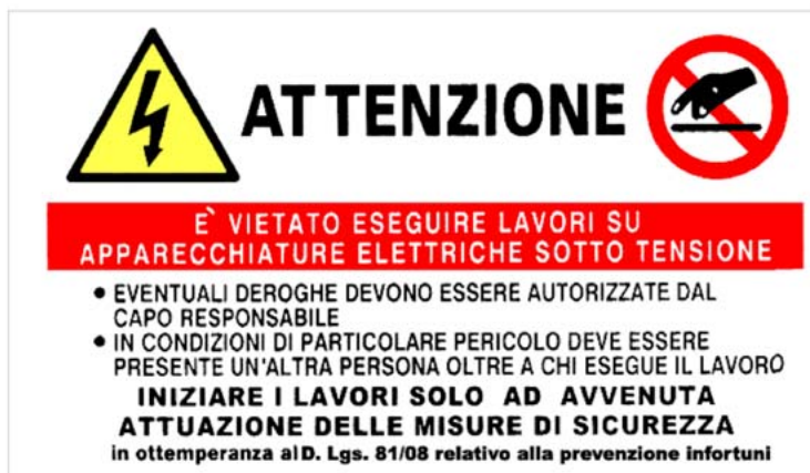
Figura 5 – Targa di attenzione sul divieto di eseguire lavori sotto tensione.
