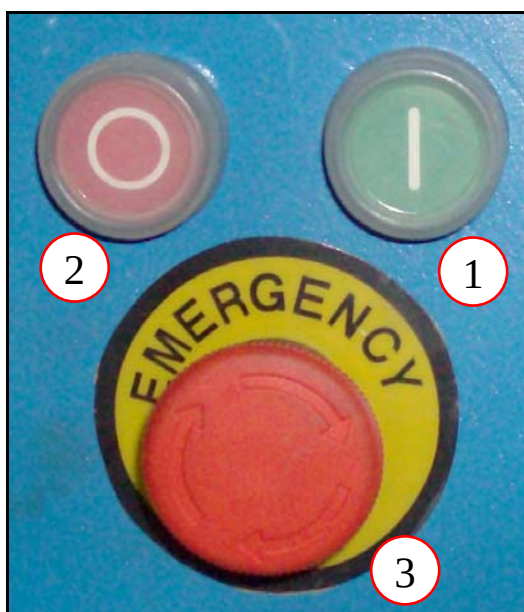
Figura 11 – Quadro comando della macchina.
