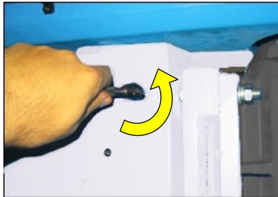
Figura 9 – Svitare le viti di bloccaggio
