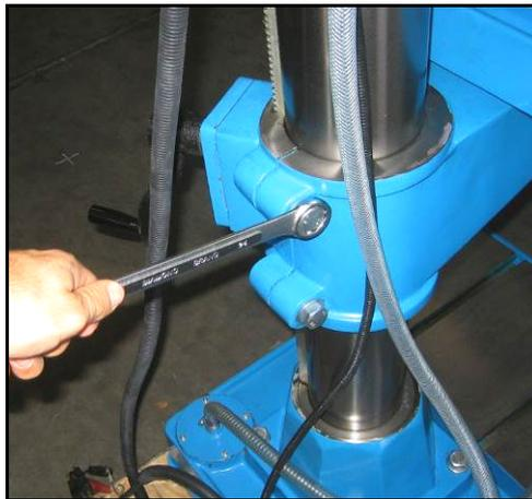
Figura 19 – Sbloccaggio viti
