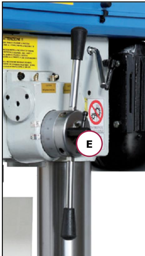
Figura 17 – Volantini di avanzamento
