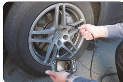
Ejemplo: Inspección pastillas de frenos
