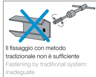
Staffa da fissare con bullone Hanger to be fixed by a bolt
