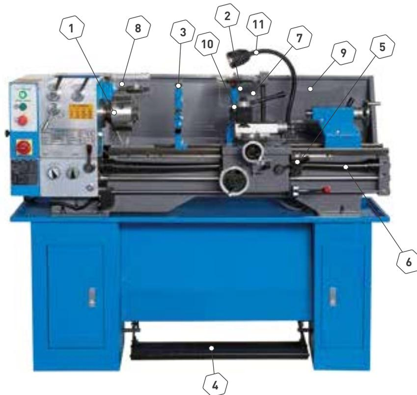
**1** Plato autocentrante 3+3 Ø 160 mm**2** Luneta móvil**3** Luneta fija**4** Freno de pie**5** Reloj de rosca**6** Protección husillo de avance**7** Protección torreta**8** Protección de seguridad para plato**9** Protección posterior contra virutas**10** Torreta de cambio rapido TOAE**11** Lámpara
