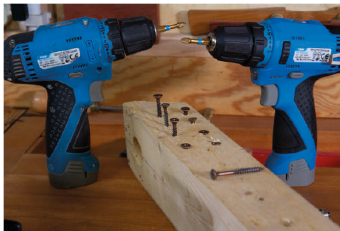
La sola differenza emersa nel confronto tra l'usato e il nuovo riguarda la soglia di intervento della frizione. Nell'immagine l'affondamento ottenuto con viti 5x50 mm e la frizione selezionata sulle posizioni 1-3-6-9; la fila di destra è relativa al trapano nuovo.
