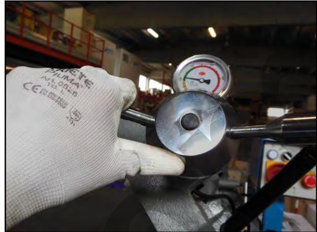
Figura 41 – Montaggio della lama e regolazione della tensione.
