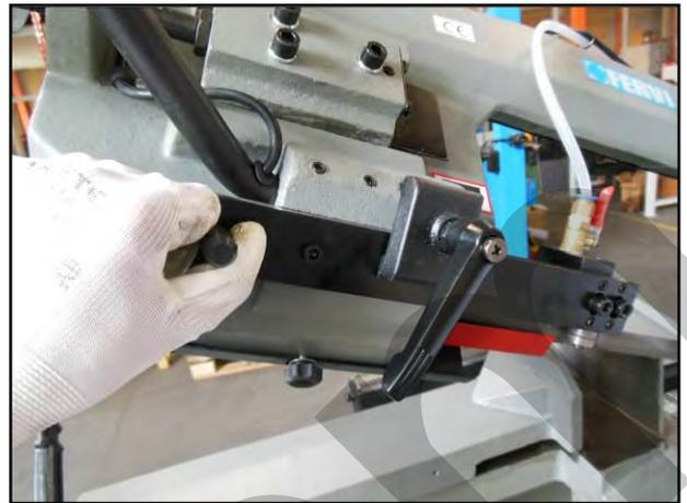
Figura 32 – Regolazione della posizione del guida lama.
