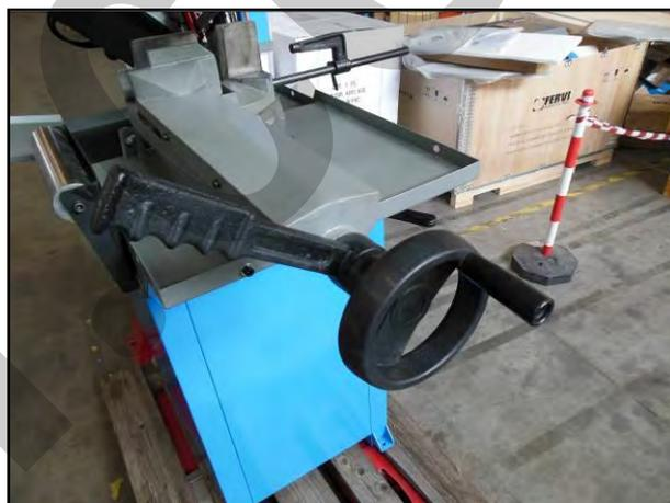
Figura 30 – Regolazione e bloccaggio della morsa.
