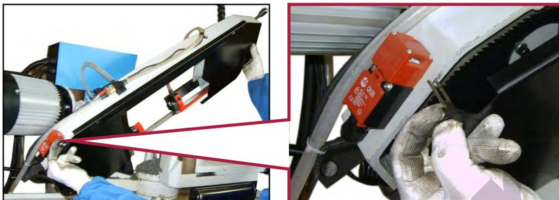
Figura 38 – Smontaggio del carter di protezione lama.
