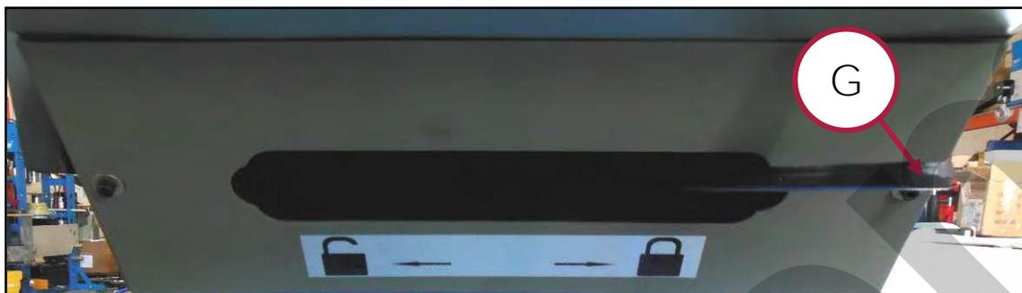
Figura 4 – Leva di bloccaggio della testa.
