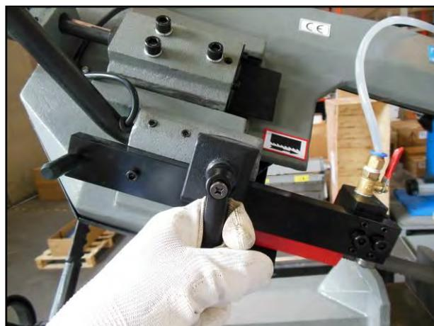
Figura 31 – Sbloccaggio vite del guida lama.
