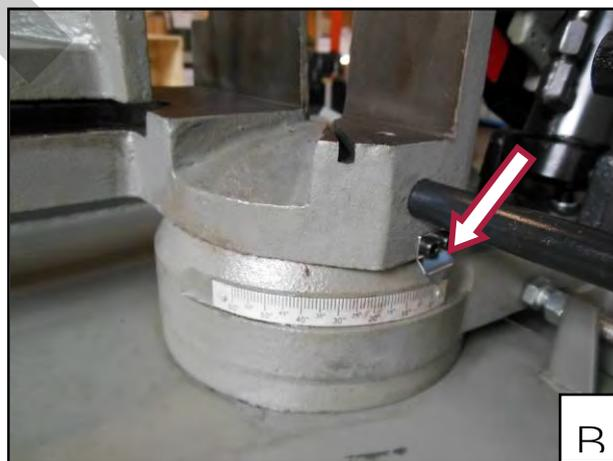
Figura 28 – Regolazione della posizione della testa.
