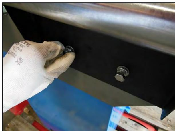
Figura 24 – Installazione del rullo di sostegno dei profilati.
