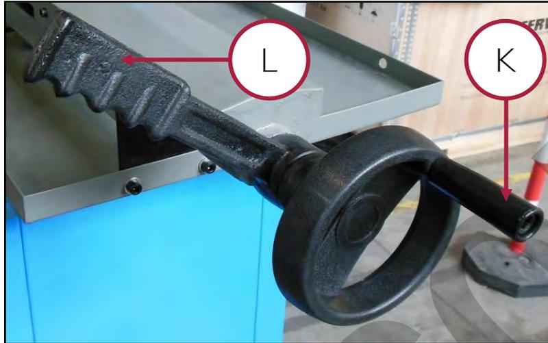
Figura 7 – Volantino e leva della morsa.
