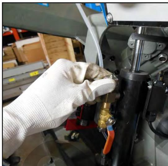
Figura 34 – Regolazione velocità.
