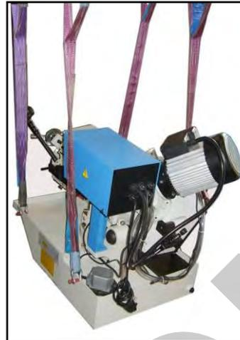
Figura 18 – Sollevamento del basamento della macchina.
