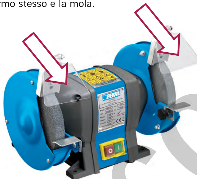
Figura 5 – Dettaglio schermi di protezione.
