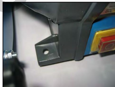
Figura 4 – Dettaglio foro di fissaggio
