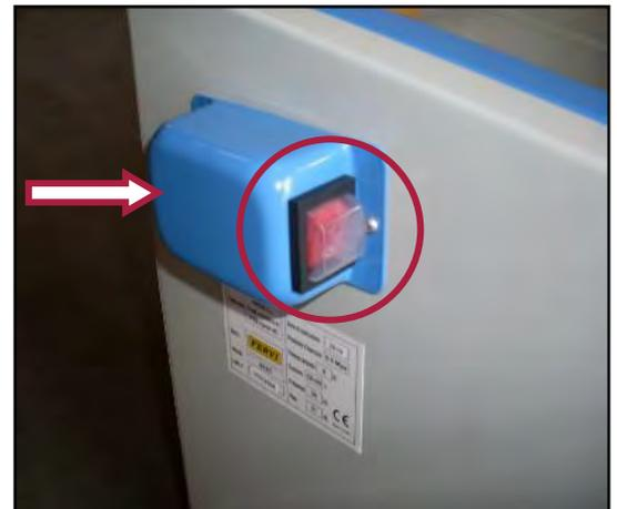
Figura 13 - Dettaglio interruttore e presa per spinotto.
