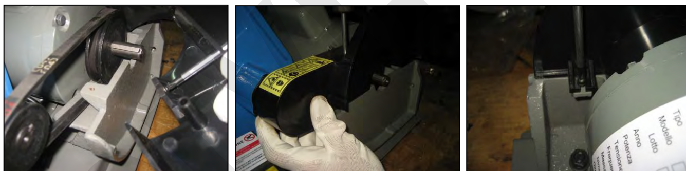
Figura 10 – Montaggio prima parte del carter della cinghia
