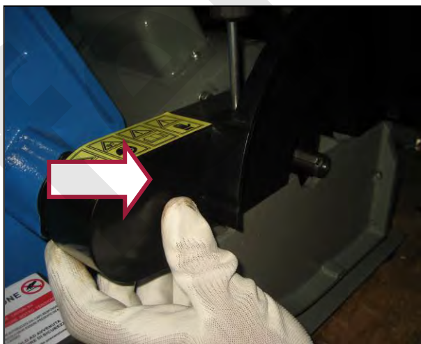
Figura 5 – Carter fissi della levigatrice.
