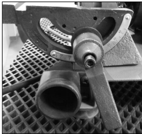
Figura 17 – Regolazione del goniometro.
